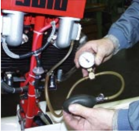
Bild 7: Prüfen auf Dichtheit
