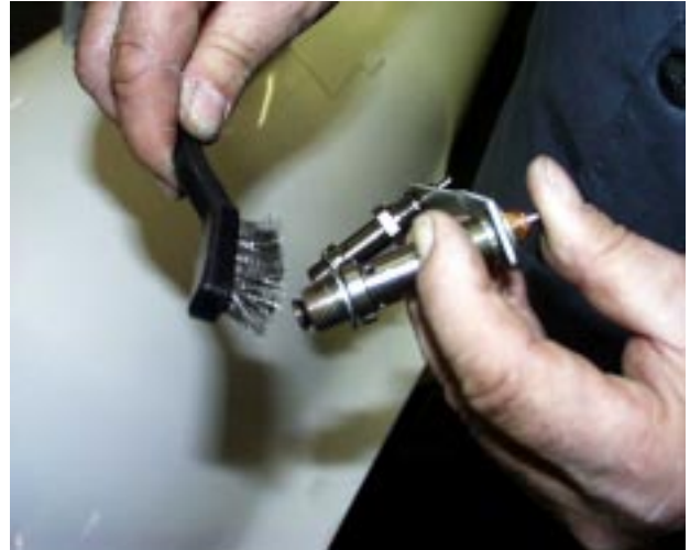
Bild 2: Reinigung der Dekompressions- ventile
