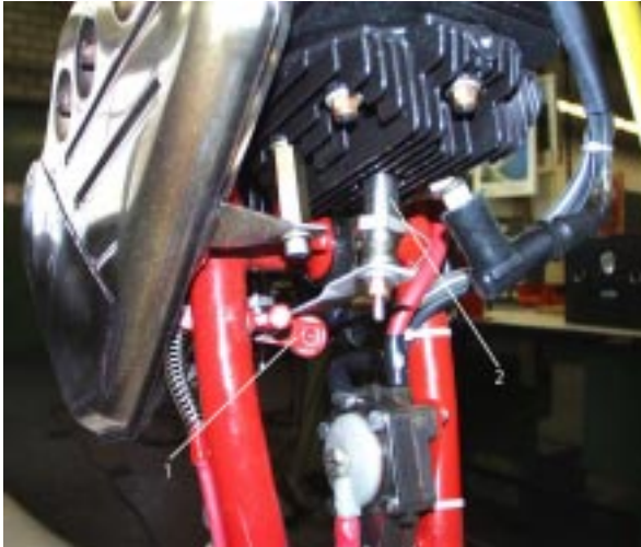
Bild 1: Ausbau der Dekompressions- Ventile
